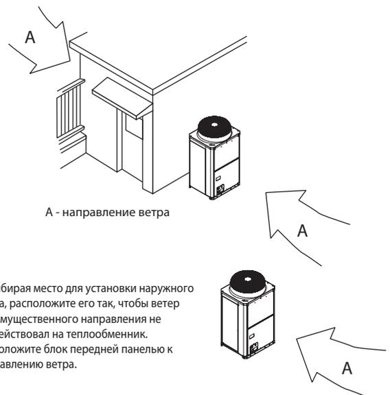
б) Выбирая место для установки наружного блока, расположите его так, чтобы ветер преимущественного направления не воздействовал на теплообменник. Расположите блок передней панелью к направлению ветра.
