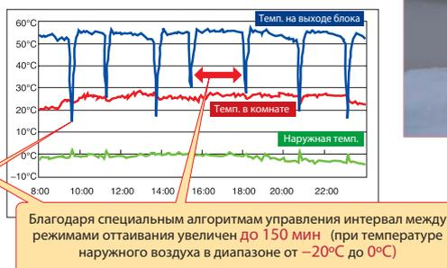
Пример эксплуатации наружного блока
