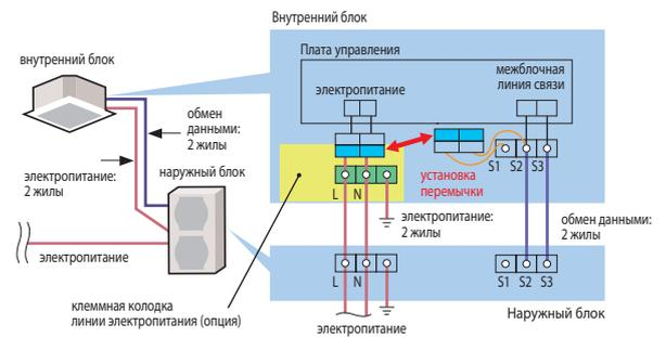
Стандартный вариант: подключение электропитания только к наружному блоку
