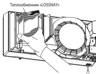
Для чистки теплообменника «LOSSNAY» следует использовать пылесос. Не допускается мыть теплообменник водой!
