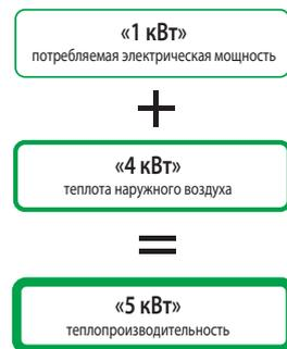
Коэффициент энергоэффективности теплового насоса:
