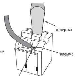
не подключайте более 1 провода в каждую клемму самозажимных клеммных колодок TB571 и TB530
