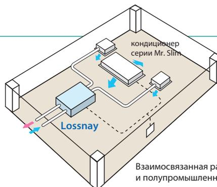
Взаимосвязанная работа вентустановки Lossnay и полупромышленного кондиционера
