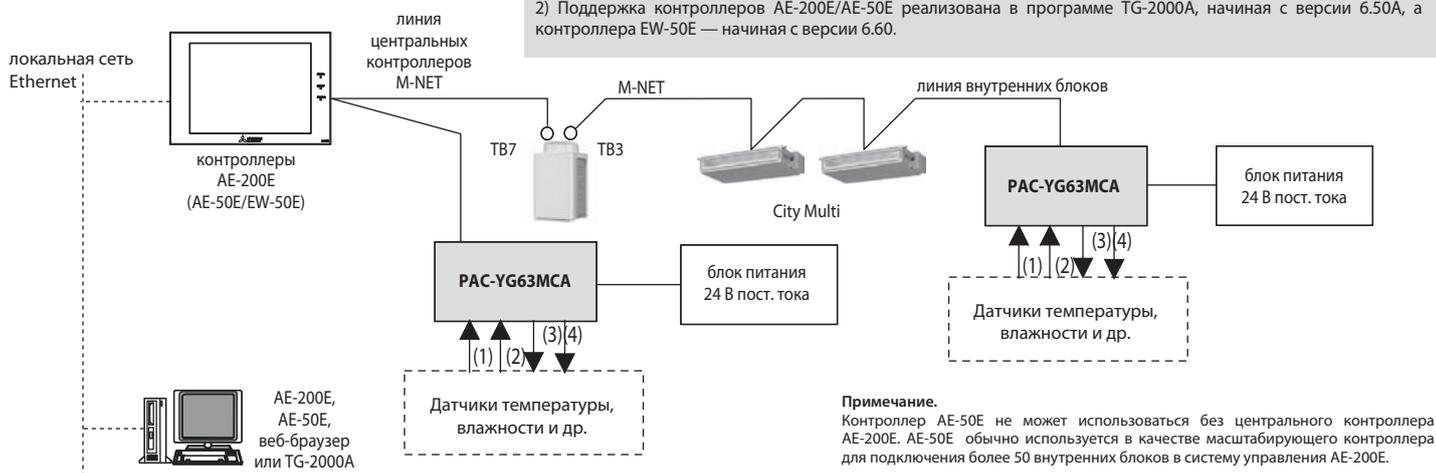
**Примечание.** Контроллер AE-50E не может использоваться без центрального контроллера AE-200E. AE-50E обычно используется в качестве масштабирующего контроллера для подключения более 50 внутренних блоков в систему управления AE-200E.
