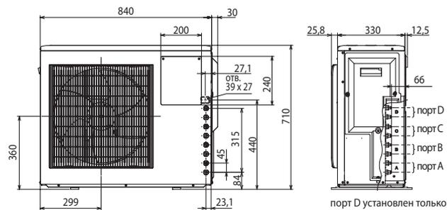
порт D установлен только в модели MXZ-4E72VA
