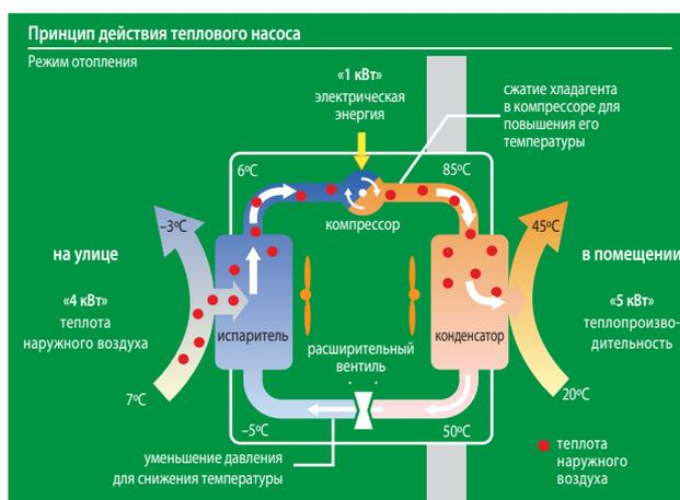
Далее этот поток поступает в теплообменник (испаритель), связанный с окружающей средой (например, воздушный теплообменник на улице). При низком давлении жидкость испаряется (превращается в газ) при температуре ниже, чем температура наружного воздуха или грунта. В результате часть тепла наружного воздуха или грунта переходит во внутреннюю энергию хладагента. Газообразный хладагент вновь поступает в компрессор — контур замыкается.
