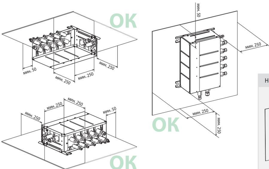
Блоки-распределители PAC-MK32BC(B) и PAC-MK52BC(B) не требуют удаления конденсата и не имеют дренажного поддона. Их можно устанавливать вертикально (крепление к стене). При этом штуцеры для подключения фреонопроводов от наружного блока должны быть направлены вниз. Другие варианты вертикального расположения блоков-распределителей недопустимы.
