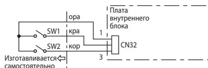
SW1: включить/выключить (действует только при замкнутом SW2)
