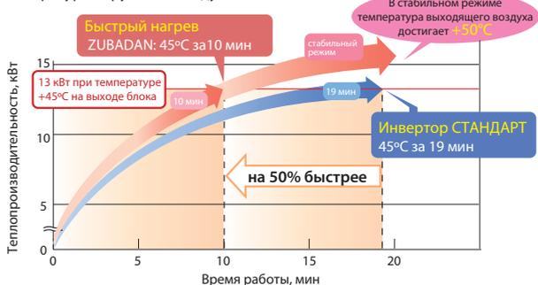
Температура наружного воздуха  $-20^{\circ}\text{C}$
