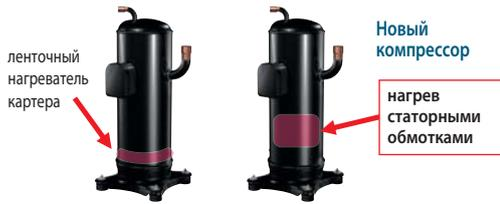
Подогрев компрессора в блоках CITY MULTI G6 осуществляется статорными обмотками электродвигателя. Это обеспечивает более эффективное использование электроэнергии в сравнении с внешним ленточным нагревателем картера компрессора.
